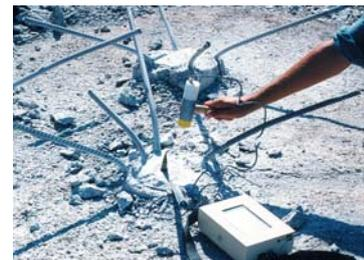
Ensayo de integridad PIT
