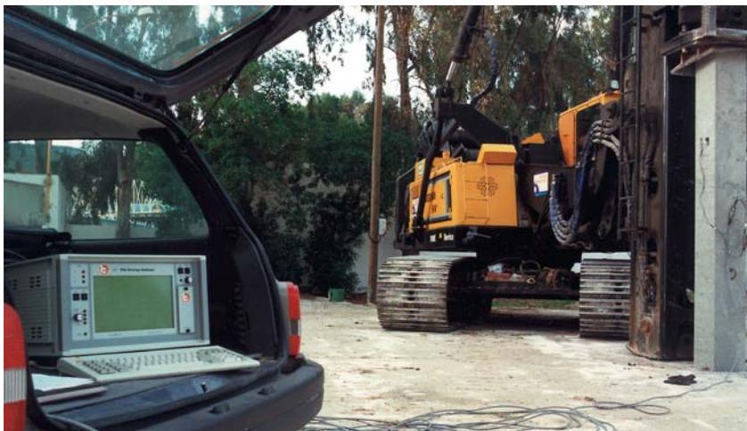
Ensayo con el analizador de hinca de pilotes
