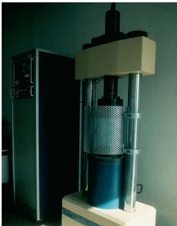
Ensayo de rotura a compresión de probetas de hormigón en Factoría
